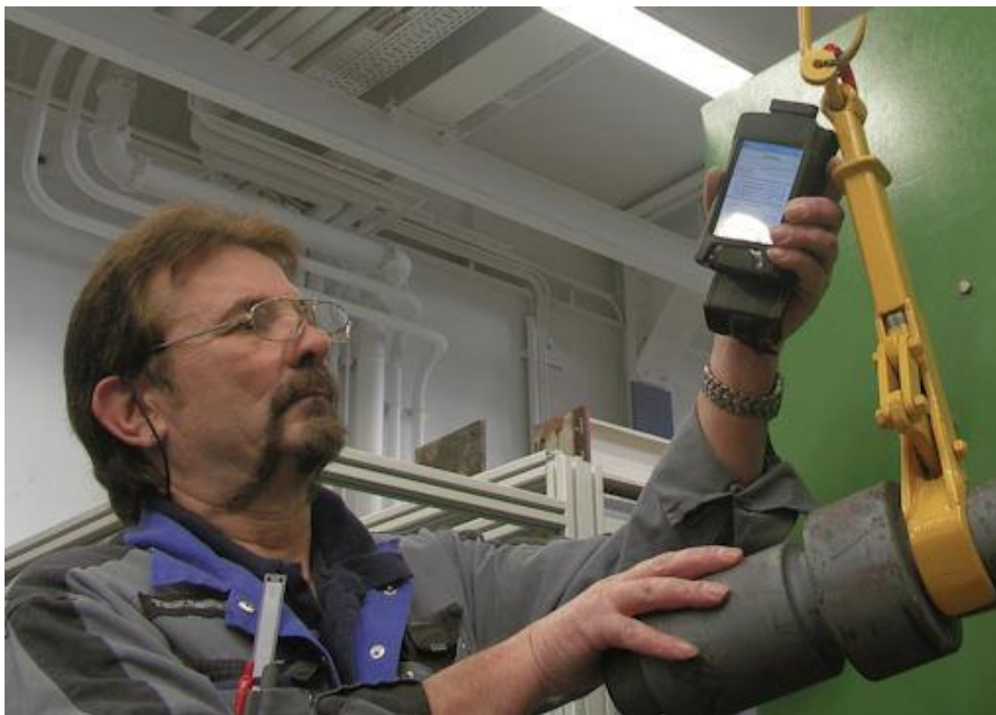
Alle Arbeitsmittel (hier ein Lastaufnahmemittel) werden mit RFID-Transpondern versehen und können so mit einem PDA (Pocket-PC) schnell identifiziert werden.
